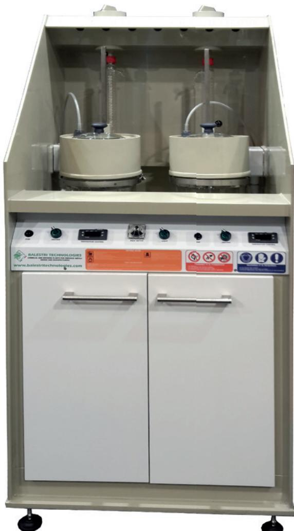
L'impianto è utilizzato, nell'ambito dell'analisi per coppellazione (ISO 11426:2014), per effettuare il processo di separazione dell'oro dal resto dei metalli in lega nel campione da analizzare. Il processo chimico di separazione, detto anche spartimento, avviene facendo reagire il campione con acido nitrico ( $\text{HNO}_3$ ).
